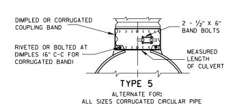
NOTE: DIMPLED BAND FITS OVER OUTSIDE OF ENDWALL. AND CORRUGATED BAND FITS INSIDE ENDWALL.
